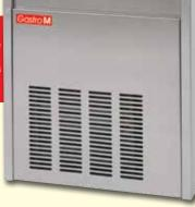
Spezinikation CT693 230V. Max. Leistung 20kg/24Std. Lagerkapazität: 10kg. Wasserversorgung ¾". Kältemittel R134A. Größe (cm): 65(H) x 40(B) x 40(T). Gewicht: 30kg.
