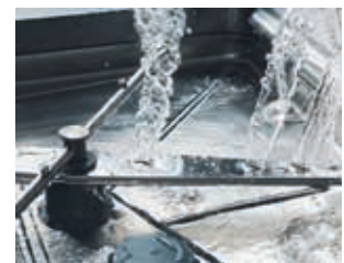
Spülarme und Tankfilter aus rostfreiem Edelstahl
