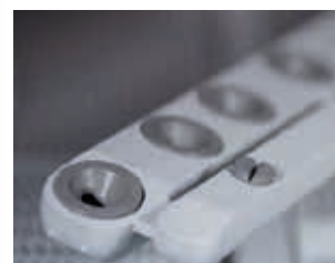
Selbstreinigende Weitwinkel-Waschdüsen zur Vermeidung von Sprüschatten
